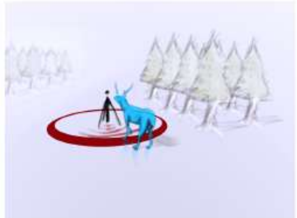
Sensorene registrerer bevægelse i feltet og sender signal til controlleren
