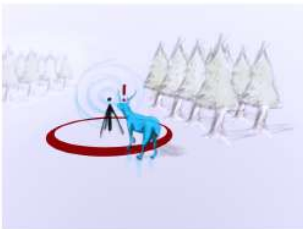
Controlleren aktiverer forskellige stimuli og gemmer informationer om dato og tidspunkt for aktivitet i sensorfeltet.
